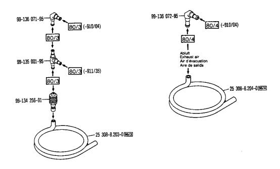
Pneumatische Anschlüsse Pneumatic connections Raccords pneumatiques Empalmes neumáticos
